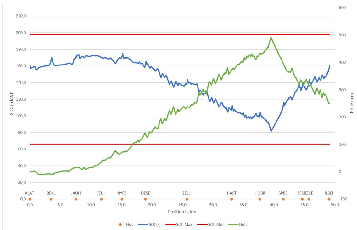
Abbildung 11: SOC-Verlauf der Dynamikbatterie, kurzer FCMU, Klatovy – Bayerisch Eisenstein
