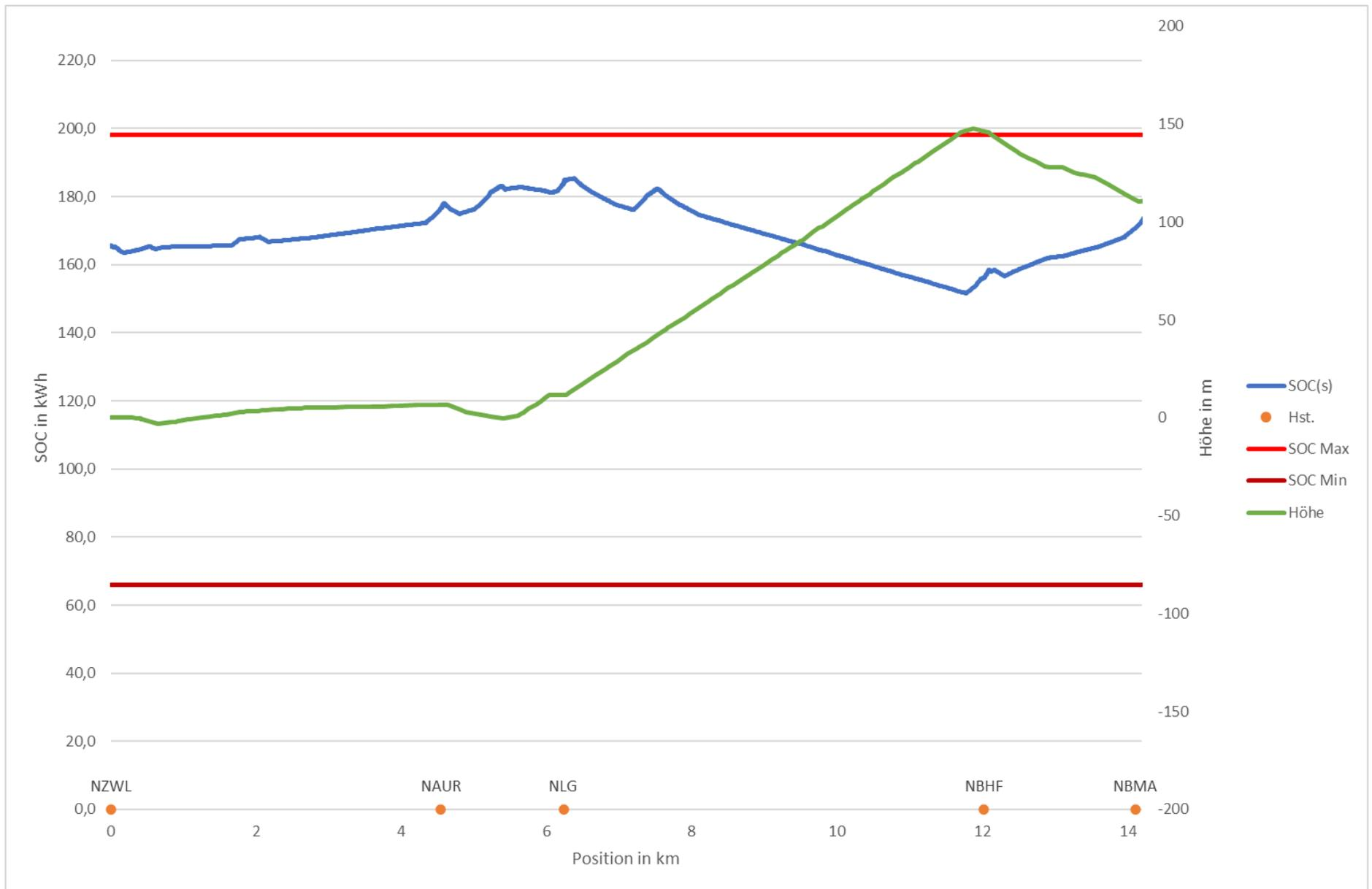
Anlage 20: SOC-Verlauf der Dynamikbatterie, langer FCMU, RB 37 Zwiesel – Bodenmais
