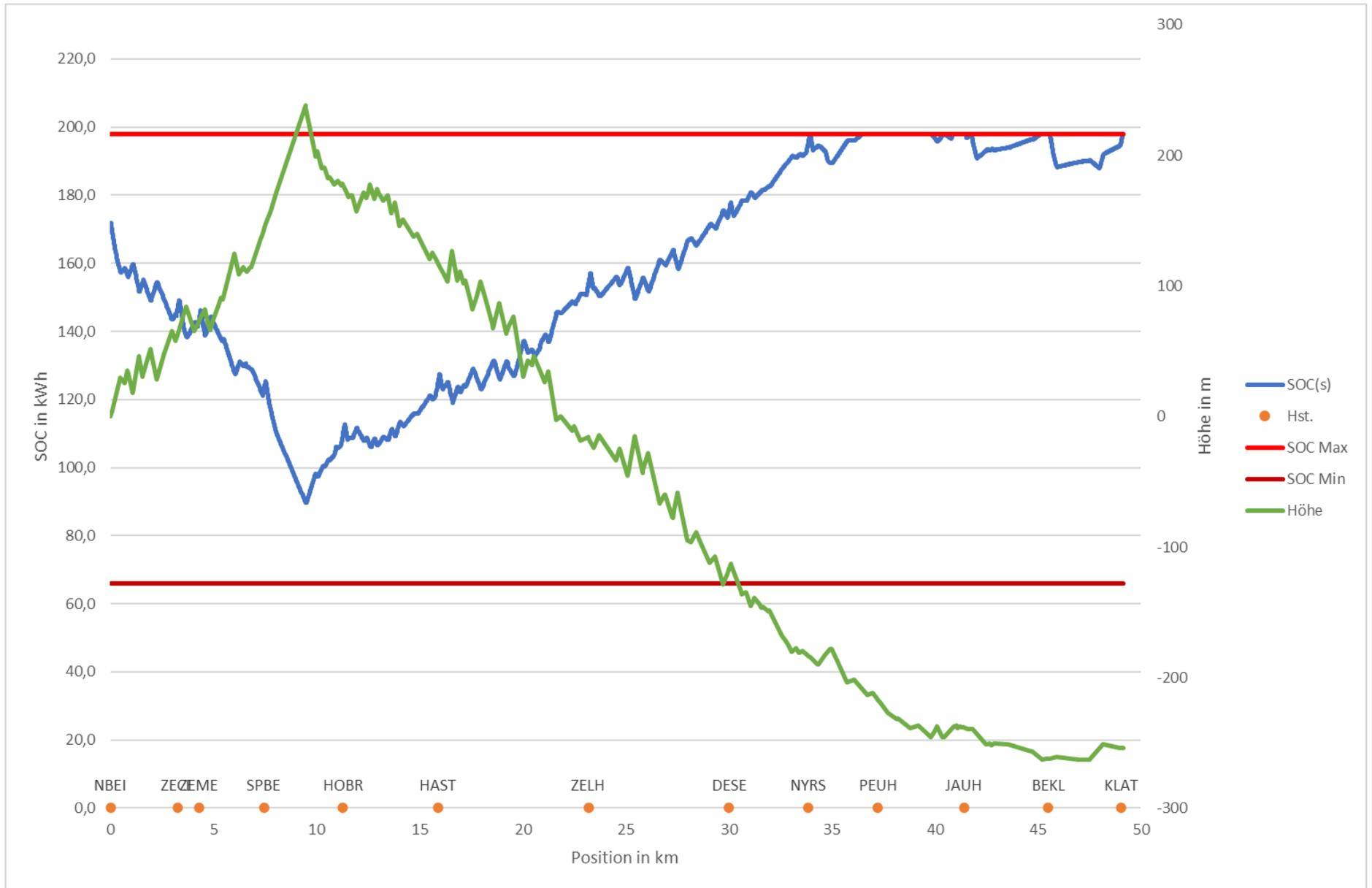
Anlage 3: SOC-Verlauf der Dynamikbatterie, kurzer FCMU, RB 35 Bayerisch Eisenstein – Klatovy
