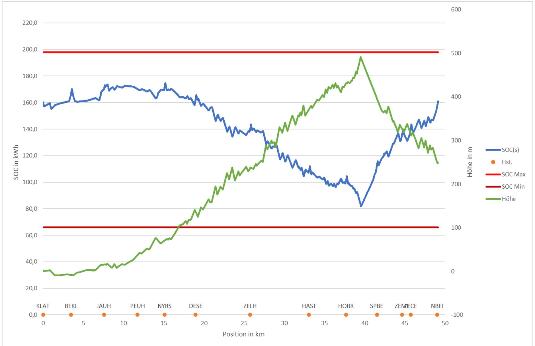
Anlage 7: SOC-Verlauf der Dynamikbatterie, kurzer FCMU, RB 35 Klatovy – Bayerisch Eisenstein
