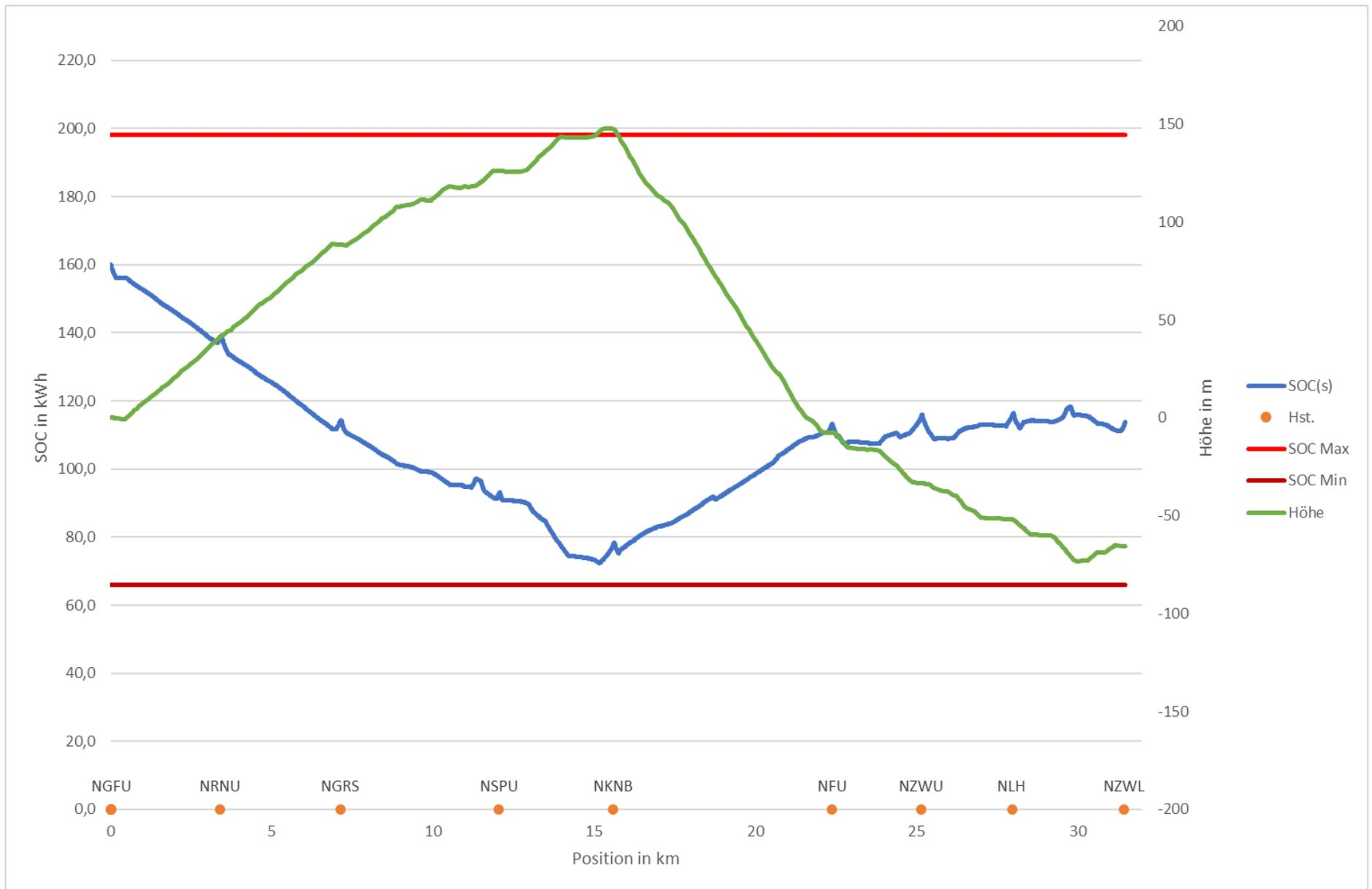
Anlage 15: SOC-Verlauf der Dynamikbatterie, langer FCMU, RB 36 Grafenau – Zwiesel
